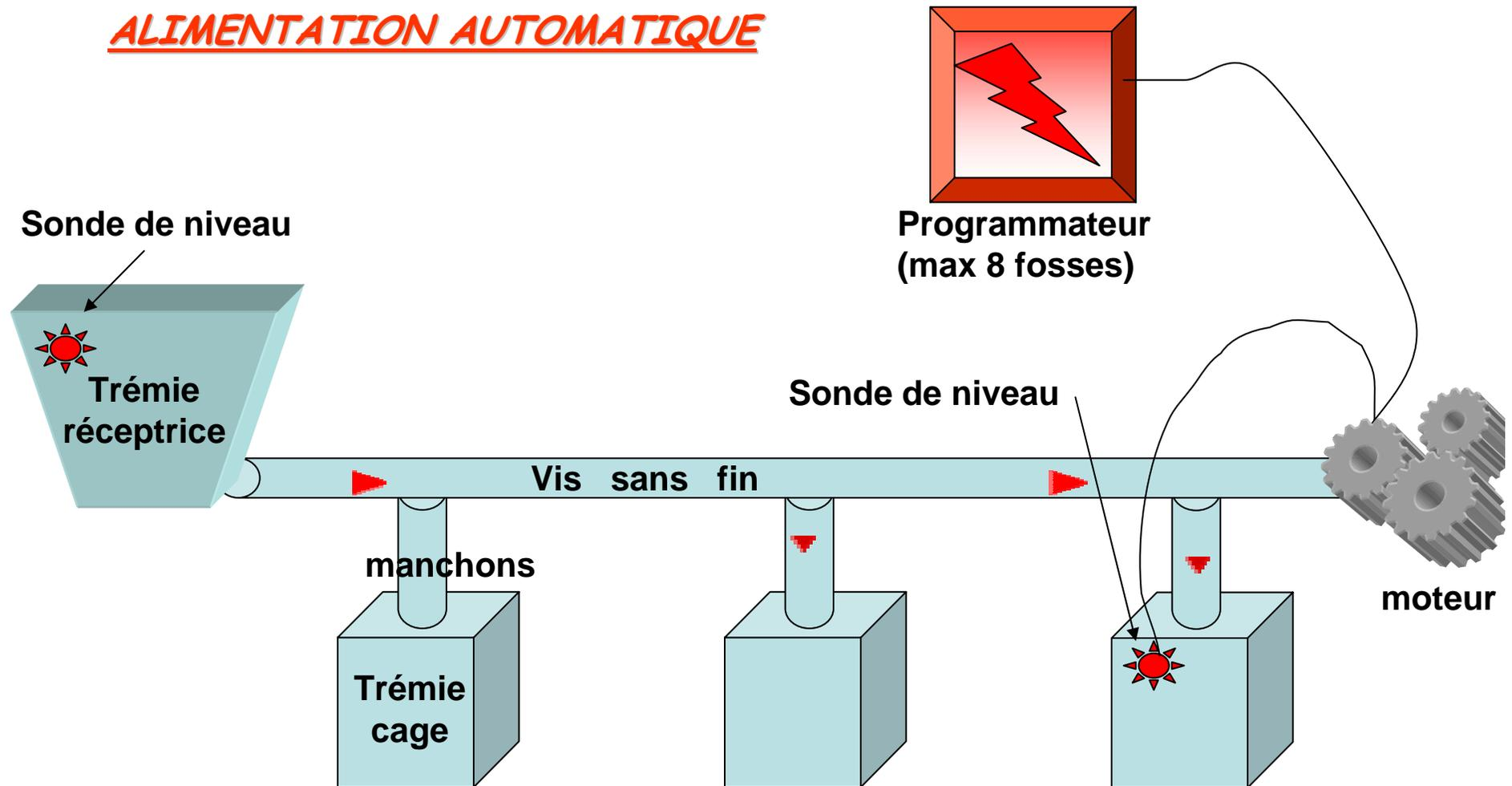
Une alimentation automatique permet de rationner les lapins en engraissement en jouant sur la durée de fonctionnement de la vis d'alimentation et sur la capacité des mangeoires situées dans les cages.
