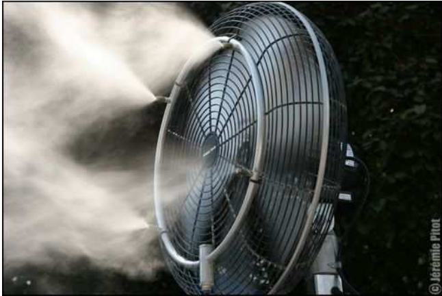
Pulvérisation d'eau devant un brasseur d'air
