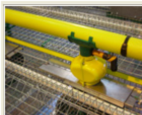
Positionnement du doseur au-dessus de la trémie d'alimentation. Entre le doseur et cette dernière une trappe à coulissement horizontal permet de faire descendre les granulés dans la trémie sur commande
