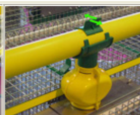
Classiquement sur la vis d'alimentation un anneau coulissant sur le tube (flèches vertes) permet d'obturer l'alimentation d'un bloc de 4 cages vides, sans aucune perturbation du niveau de rationnement des autres blocs
