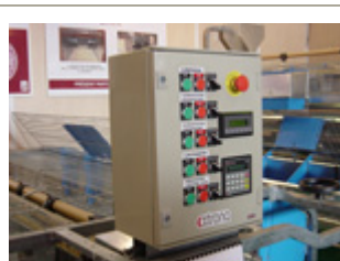
Boitier de commande centralisée des automatismes pour l'éclairage, la distribution des aliments pour mères et pour lapereaux, l'allaitement contrôlé et l'abreuvement contrôlé. Marque Extrona
