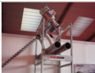
Dispositif original permettant de mélanger un aliment "additif" dans le flux de granulé d'une alimentation automatique (de 0,7 à 2,3 kg/mn). Distribution sur 1 ou 2 tubes. Equipement Dosa-pellet marque Contro Fratelli
