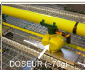
Le doseur placé sous le tube apportant les granulés, et au-dessus de la trappe horizontale. Toutes les trappes d'une rangée sont reliées entre elles et sont donc commandées en même temps.
