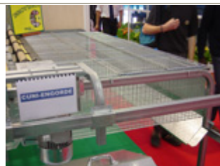
Cages classiques en disposition flat-deck pour l'engraissement collectif des lapins par groupes de 6-8 en fonction de la surface et du poids final prévu. Marque Extrona
