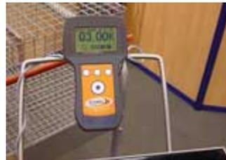
Le boîtier électronique affichant le poids, le nombre de lapins effectivement pesé, le N° du lot et celui de la cage en cours de pesée. Au bureau il est possible de corriger des valeurs et de faire une connexion simple avec un ordinateur pour stockage définitif
