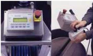
Le boîtier de commande et le joystick servant à la programmation du Robot Cleaver Clean
