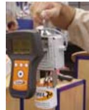
Le boîtier électronique peut aussi être adapté à une pesée "au crochet" en utilisant un autre capteur de force.
