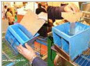
Jeu de Cloisons mobiles permettant de une partie avant/arrière ou une partie droite /gauche de la trémie Matériel Extrona
