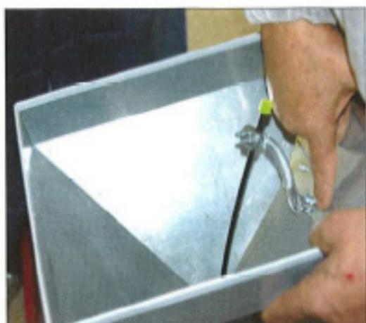
▲ La tige est rappelée par un ressort qui lui permet de reprendre son axe en frappant le tube de descente. Un mouvement triangulaire avec choc qui fait tomber le complément. Ce système créé par Hervé Caillé régularise de façon homogène la descente du complément vers la vis sur rangée.
