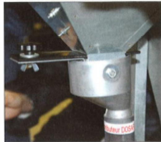
▲ La trappe à 10 positions permet de régler le débit de distribution du complément. C'est à l'éleveur de paramétrer le système.
