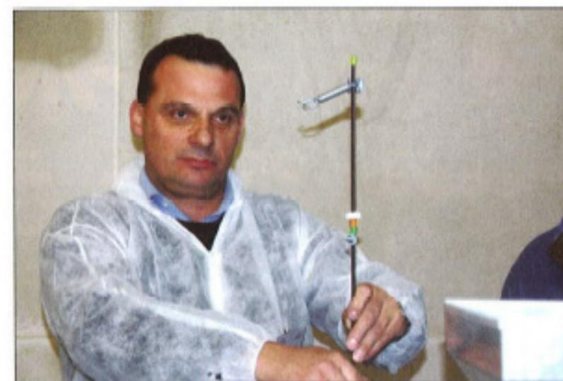
▲ L'agitateur doit dépasser d'environ 9-10 mm dans le tube. Un écrou frein situé en son milieu permet de valider le réglage. Si les vibrations sont faibles ou si au contraire elles sont trop fortes, alors il faut changer la position de l'agitateur grâce au serre-tige. Le réglage est définitif.
